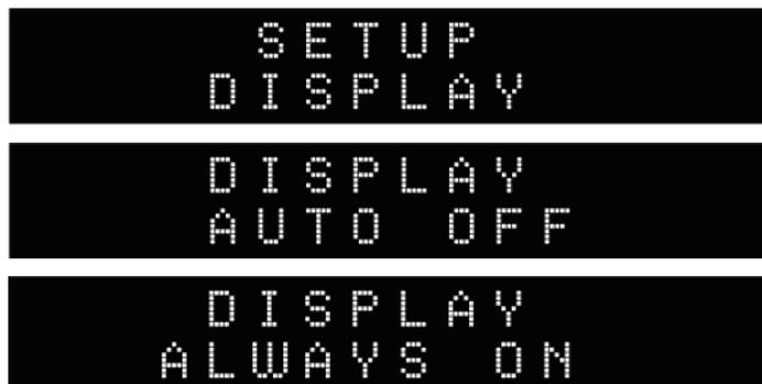
設定の結果はリアルタイムで直ちに見ることができます。「DIM」キーを使うと、現在の設定の状態を示すメッセージが短時間ディスプレイに表示されます。
