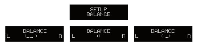
エンコーダーを反時計回りに回す、またはリモコンの「◀」キーを押すと、左チャンネルの方が音量が大きくなります。同様に、エンコーダーを時計回りに回す、またはリモコンの「▶」キーを押すと、右チャンネルの方が音量が大きくなります。
