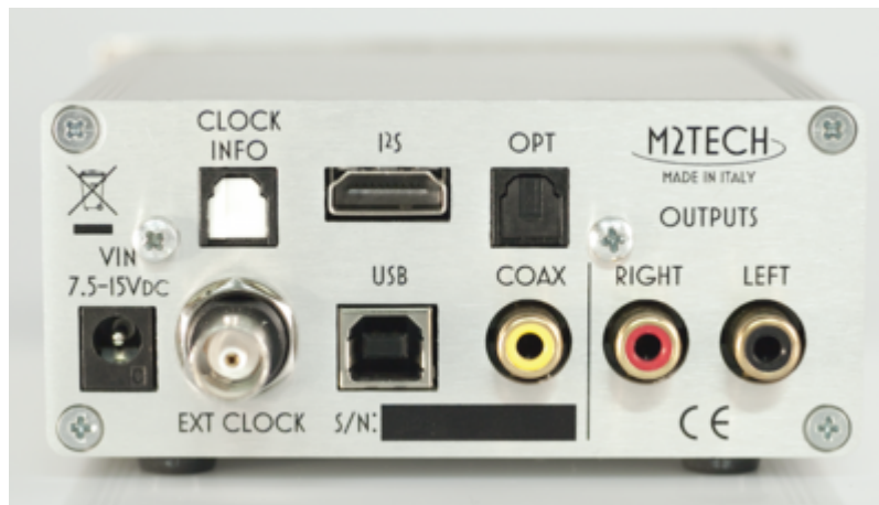
I2SはHDMIケーブルのアサインを用いるPSオーディオ方式です。
